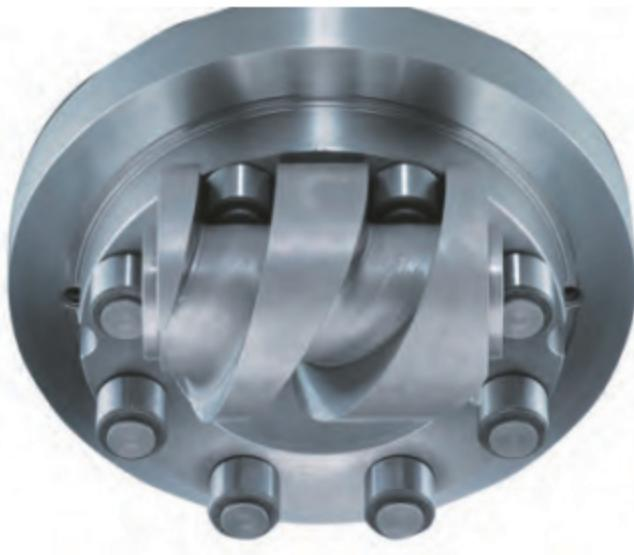
圆柱凸轮旋转分度台是输入轴上的共轭凸轮与输出轴上的分度轮无间隙垂直啮合的一种传动装置，凸轮廓面的曲线段驱使分度轮转位，轮廓面的直线段使分度轮静止，并定位自锁，通过该机构将连续的输入运动转化为间歇式的输出运动。
